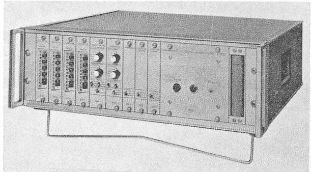
Le problème de l'adaptation des différents niveaux et logiques de sortie des voltmètres digitaux a été résolu d'une façon très élégante avec un tiroir « interface » permettant la connexion de tous les appareils à sortie BCD.
