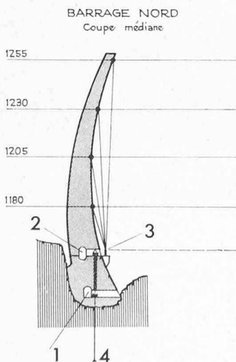
Fig. 3. — Combinaison de pendule et mesures angulaires.
