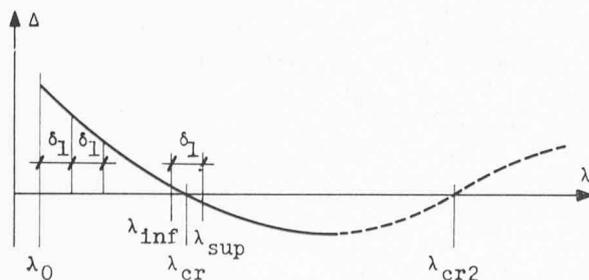
Fig. 12. — Courbe  $\lambda$ - $\Delta$  d'un cadre.
