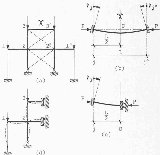
Fig. 16. — Flambage symétrique d'un cadre dont l'axe de symétrie passe par le milieu d'une travée.
