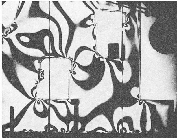
Cas de charge  $G_1 + P + W$ ,  $E_1 : E_2 : E_3 = 1 : 1/2 : 1/6$ ,  $\mu = 1,0$ , Isochromes demi-ordres (polaroïdes parallèles, polarisation circulaire). Définition du cliché selon figure 12. On notera l'effet de bord dû au vieillissement ainsi que la diminution des contraintes au point  $I_7$ .
