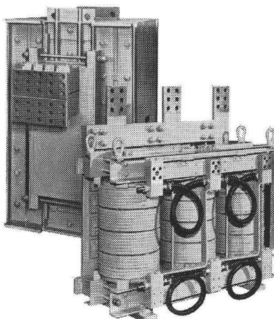
Transformateur triphasé, refroidi par l'eau, pour redresseur mobile (CERN, Genève).
