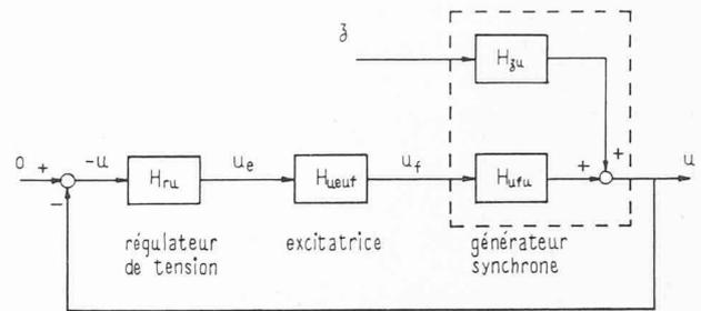
Fig. 7. — Diagramme fonctionnel du réglage de tension.
