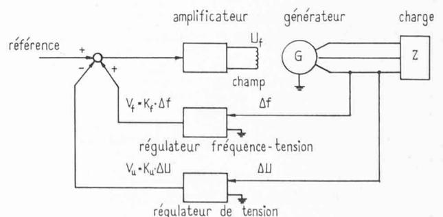
Fig. 8. — Schéma de principe de l'asservissement fréquence-tension.
