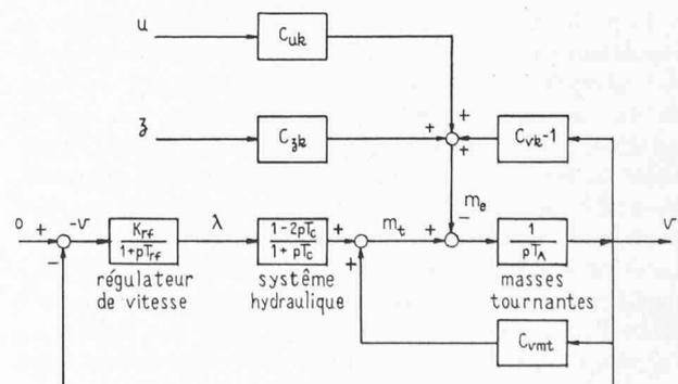
Fig. 5. — Diagramme fonctionnel du réglage de vitesse.
