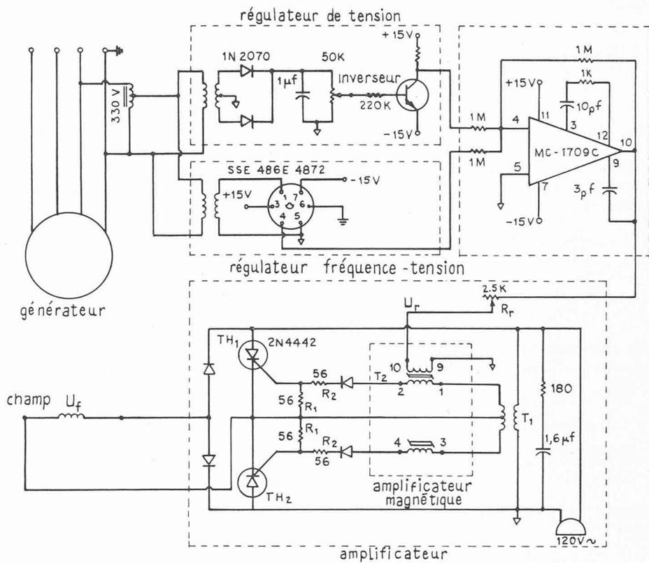
Fig. 9. — Circuit de l'asservissement fréquence-tension.
