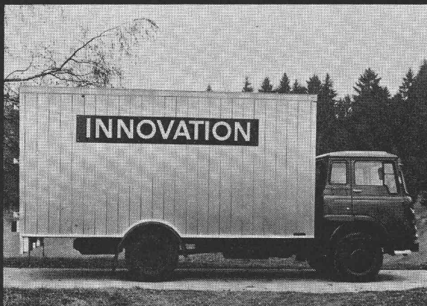
Superstructure robuste d'un fourgon en profilés aluminium
