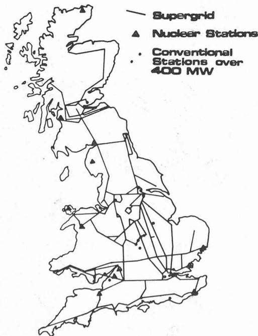
Fig. 12. — Réseau d'interconnexion des usines de production d'énergie.
