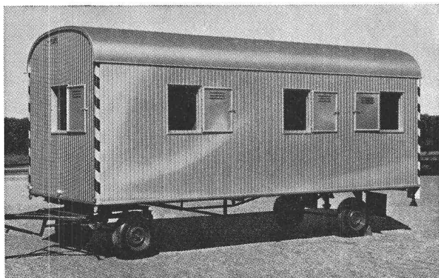
Longueurs : 1 axe : 3 à 5 m - 2 axes : 4 à 8 m
