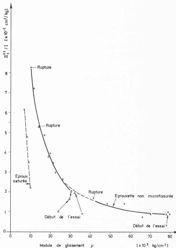
Fig. 8. — Loi contrainte-déformation pour un grès.
