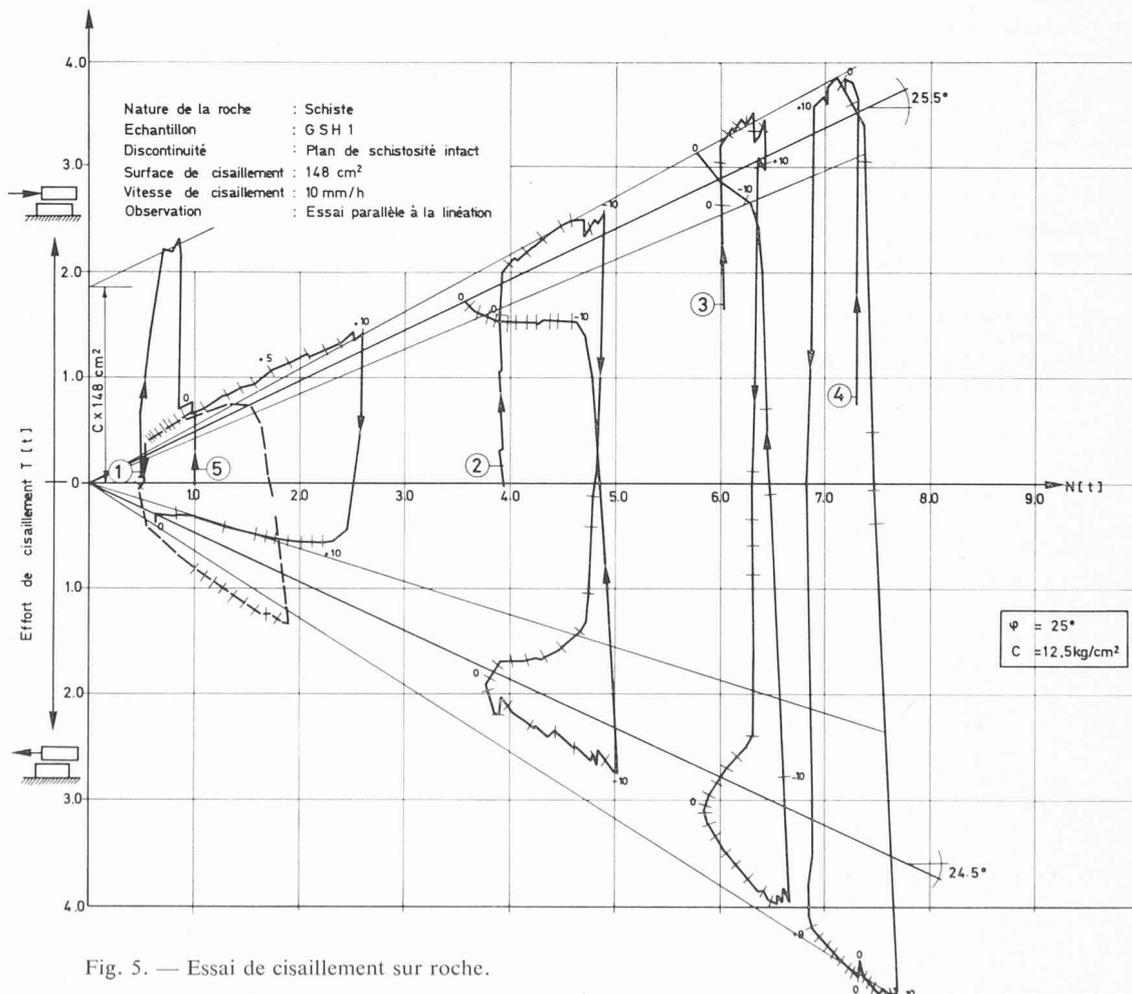
Fig. 5. — Essai de cisaillement sur roche.
