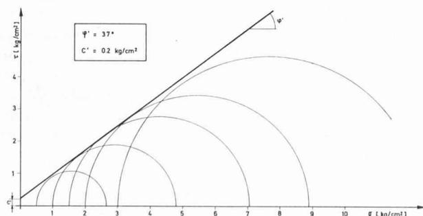
Fig. 2. — Diagramme de Mohr pour un sable compact.
