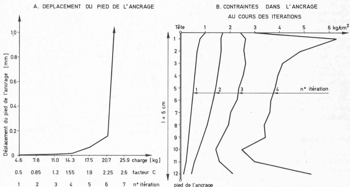
Fig. 10. — Calcul par la méthode des éléments finis.
