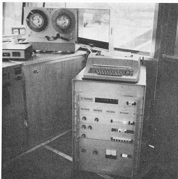
Fig. 2. — Analyseur de l'état géométrique des voies.
