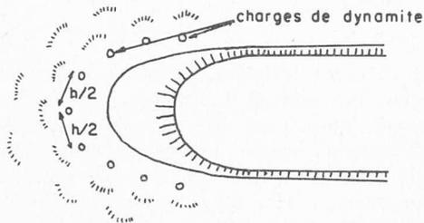
Fig. 10. — Déplacement de la tourbe par surcharge et sautage en front de remblai.
