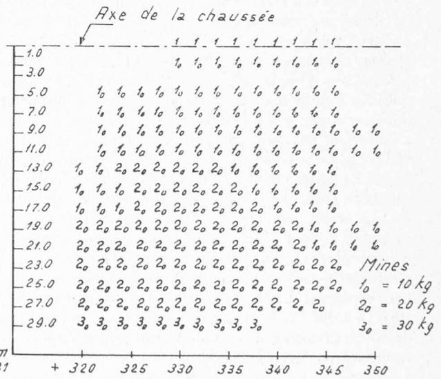
Fig. 15. — Conditions au site de construction d'un remblai par sautage sous le remblai. (D'après Garras, 1965)
