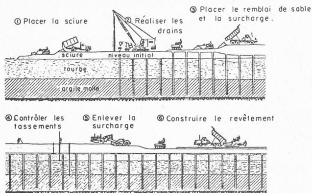
Fig. 23. — Technique de construction utilisant la sciure de bois. (D'après Lea & Brawner)
