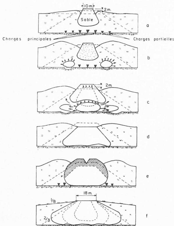
Fig. 13. — Procédé allemand d'explosion sous le remblai.
