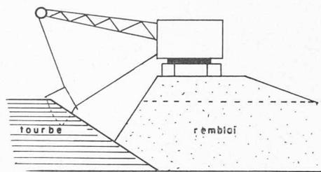
Fig. 5. — Déplacement en front de remblai.
