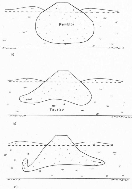
Fig. 8. — Tassements caractéristiques d'un remblai sur tourbe.
