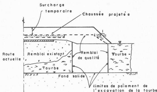
Fig. 4. — Section type dans le cas de l'élargissement d'une route. (D'après Moore, 1966)
