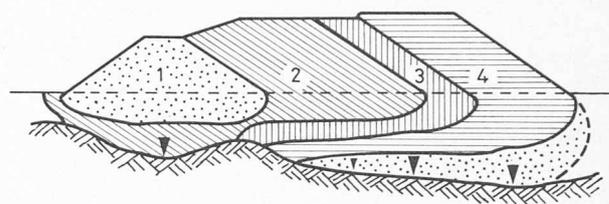
Fig. 14. — Micro-explosions assurant la progression latérale du remblai.
