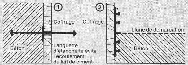
\*DR: pour joints de dilatation, encastrement au bord en béton AR: pour joints de bétonnage, encastrement au bord en béton DK: pour joints de dilatation, encastrement dans les éléments en béton AK: pour joints de bétonnage, encastrement dans les éléments en béton
