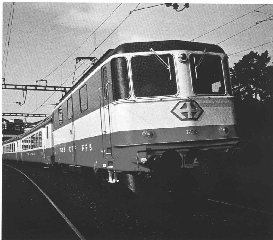
Fig. 12. — Rame automotrice de banlieue 3320 CV, 125 km/h.
