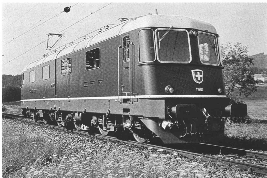
Fig. 10. — Locomotive Re 4/4 II pour trains directs et de marchandises : 6320 CV, 140 km/h.
