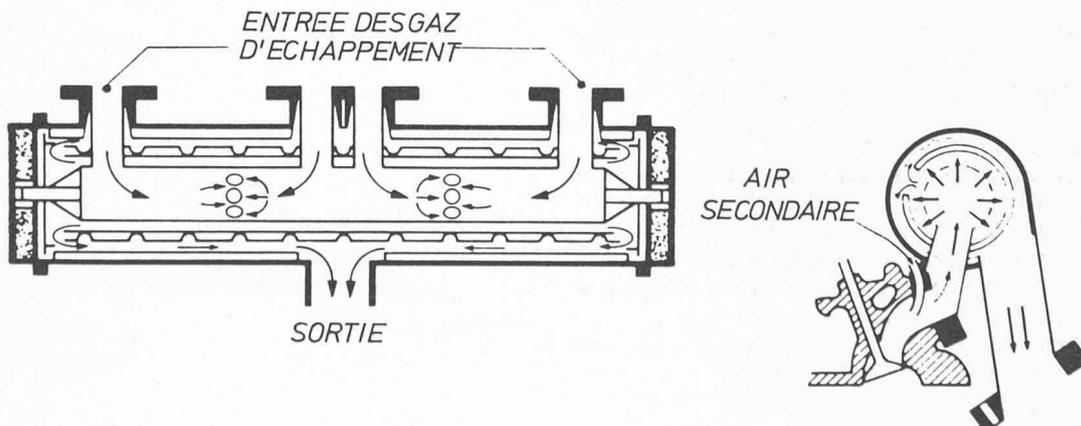
Fig. 28. — Réacteur thermique d'après Cantwell [34].
