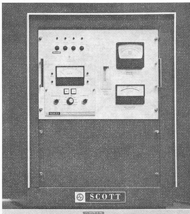
Fig. 20. — Analyseur NO-NO<sub>x</sub> (Scott).
