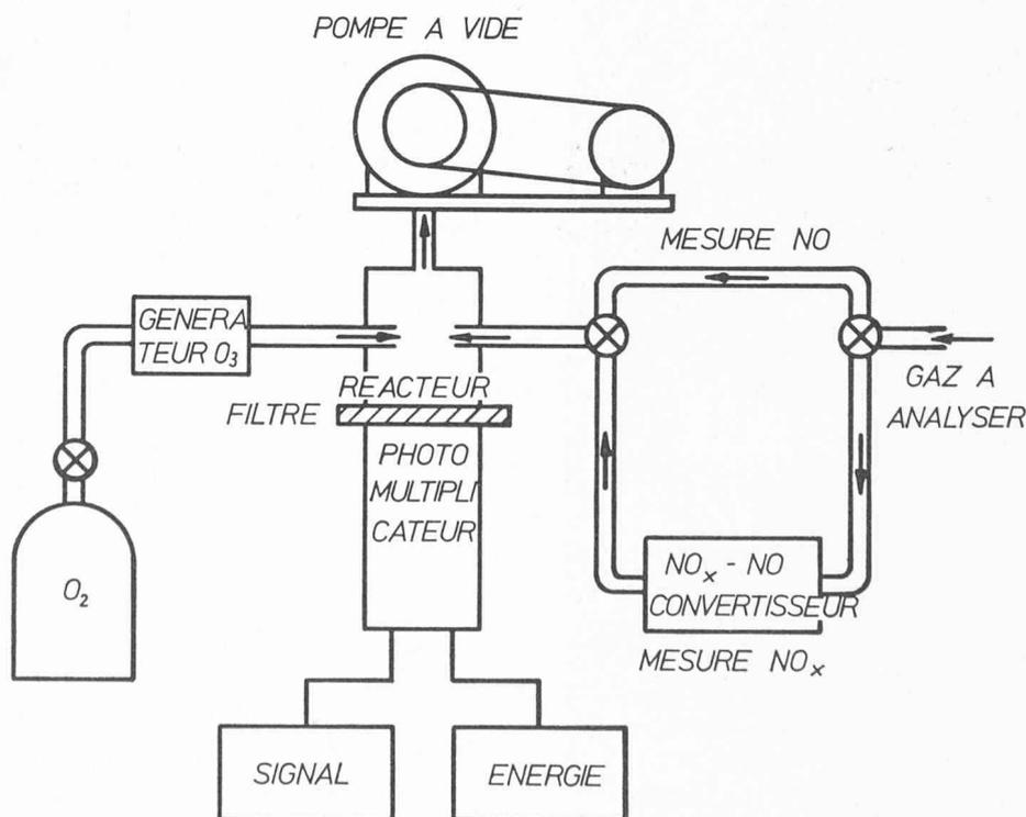
Fig. 19. — Schéma du principe des analyseurs fonctionnant selon le principe de la chimiluminescence.
