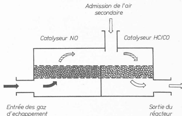
Fig. 30. — Schéma d'un réacteur catalytique à double couche.
