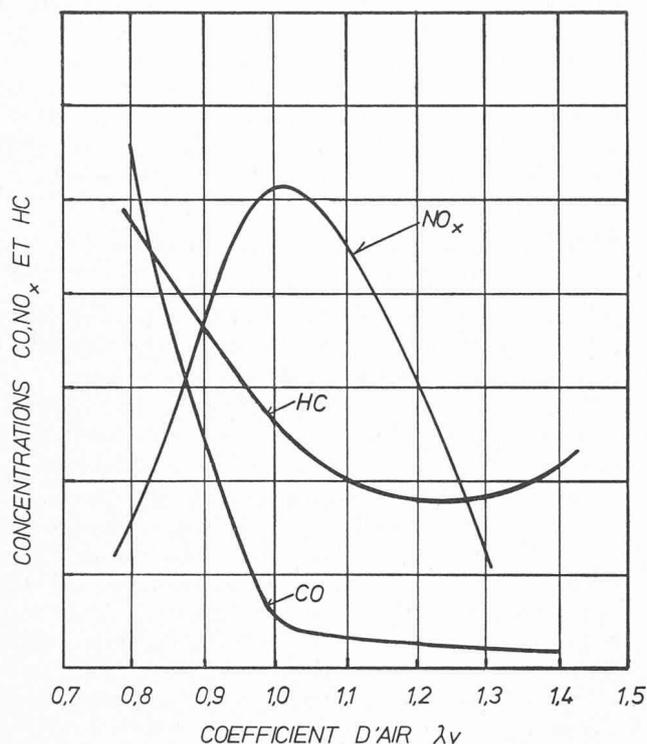
Fig. 26. — Emission caractéristique du moteur à essence.
