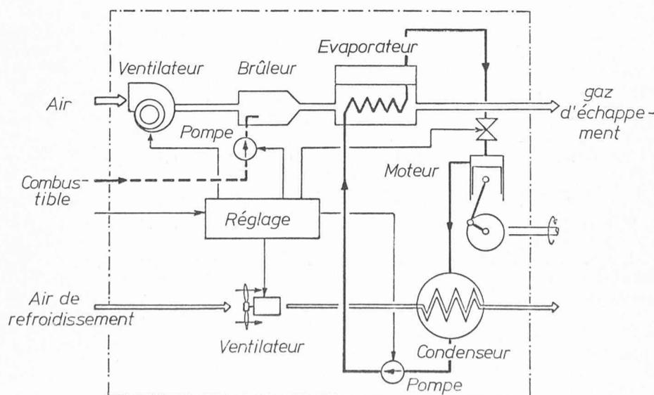
Fig. 34. — Principe du moteur à vapeur.
