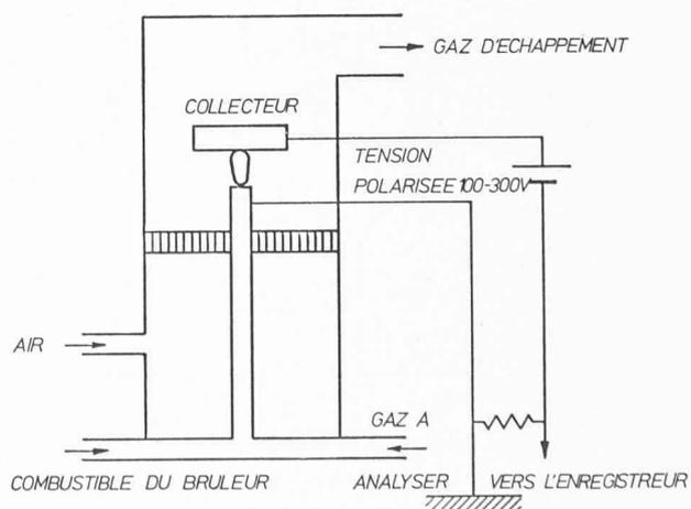
Fig. 17. — Schéma du principe FID.
