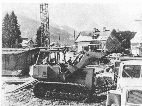
Les pelles et niveleuses K 12 d sont dès maintenant dotées d'un moteur diesel Hanomag série D 900, 6 cylindres et 9500 cc de cylindrée, puissance maximale 140 ch DIN/160 chSAE ou 103 kW à 2200 tours/minute. Il s'agit donc d'un vrai moteur de machine de chantier à faible course et vitesse moyenne du piston, travaillant sans problèmes même dans des déclivités importantes. Un nouveau système d'injection assure une consommation de carburant très économique.
