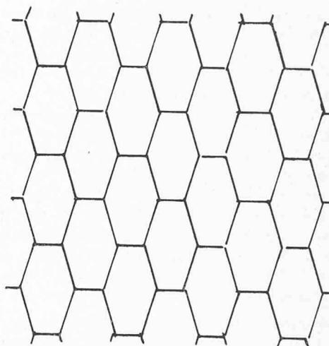
Dalabelle, une fois posée, offre un coup d'œil agréable. Des demi-pièces permettent des angles droits. Elle mesure 40 × 24 × 5 et pèse 8,5 kg. Il faut environ 13 pièces pour obtenir 1 m<sup>2</sup>.
