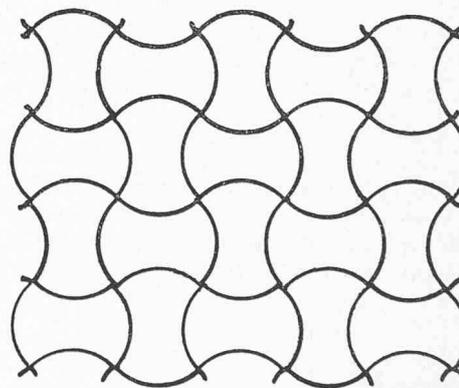
Dalanette, comme la précédente, a une apparence de béton taloché. Les arrondis s'emboîtent parfaitement. Elle mesure 40 × 28 × 5; par conséquent, il faut compter 12 pièces environ pour 1 m<sup>2</sup>. Son poids est de 10 kg par pièce. Nous fabriquons également des demi-pièces dans les deux sens.
