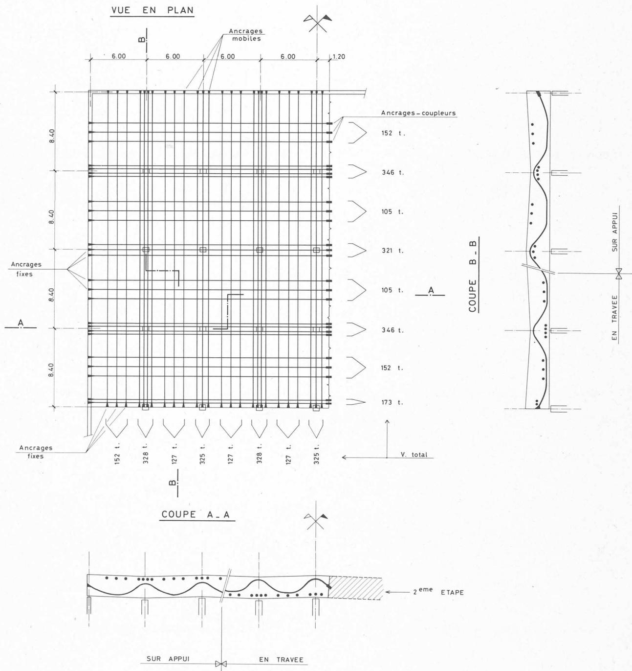
Fig. 2. — Exemple de câblage pour une étape de bétonnage de la zone 2.
