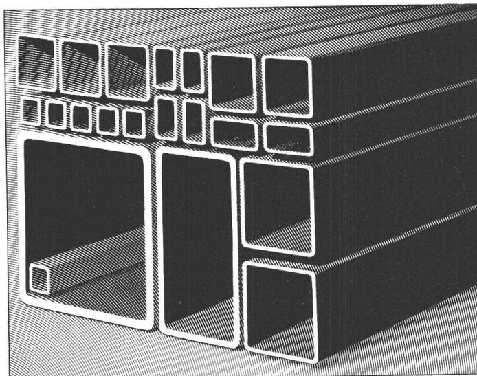
Fabriquées à chaud en aciers RSt37-2, St42-3 ou St52-3. Sur demande, également en aciers spéciaux, tels qu'aciers résistant aux intempéries ou aciers à grains fins. En longueurs de 6 à 16 m.
