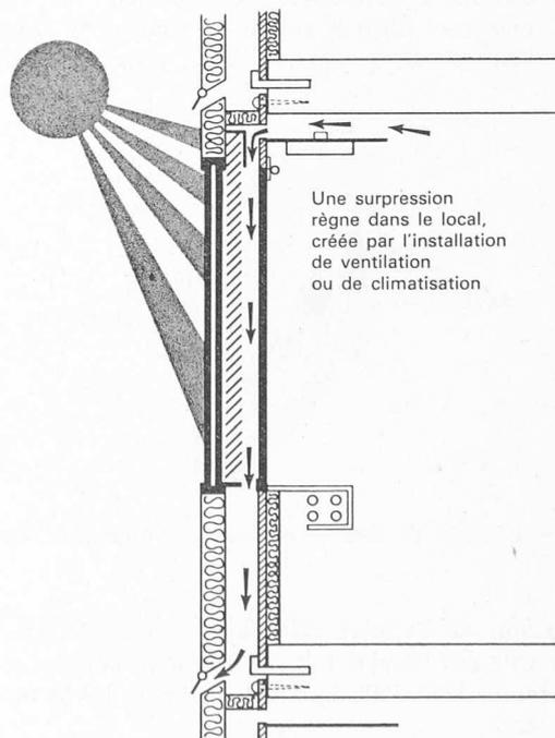
Fig. 3. — Élément climatique de façade type « Protecta-Sol »
