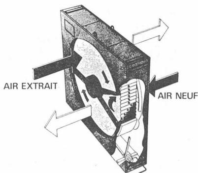
Fig. 4. — Principe de fonctionnement de l'échangeur rotatif.
