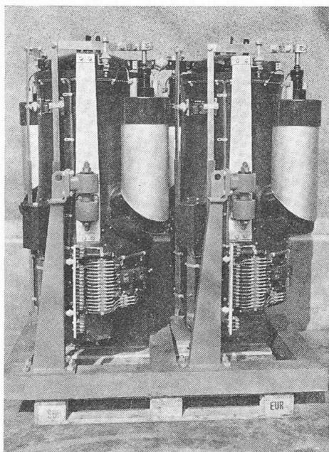
Fig. 26. — Deux cuves de redresseur à vapeur de mercure SÉCHERON, du type excitron à commande par grille, de 640 kW chacune, pour les chemins de fer indiens (IR).
