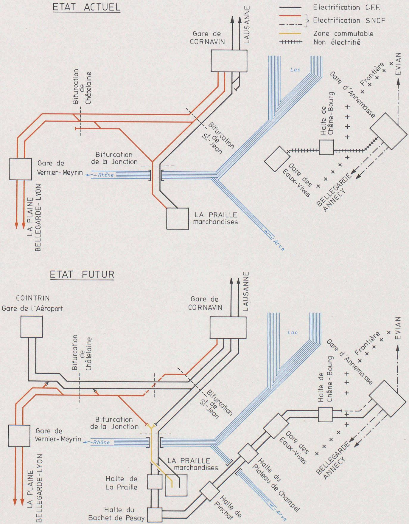
Fig. 39. — Plan schématique du réseau ferré genevois à l'ouest de la gare de Cornavin (situation actuelle).
