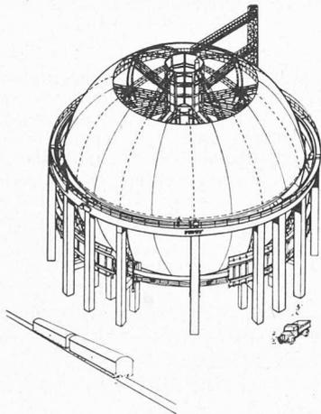
Dessin montrant la structure du réservoir sphérique.
