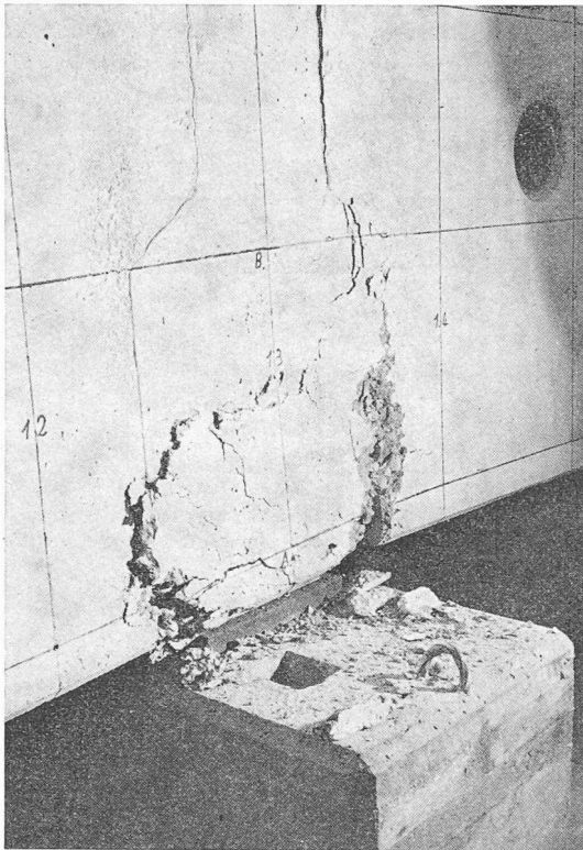
Fig. 10. — Ecrasement de la zone comprimée sur appui.
