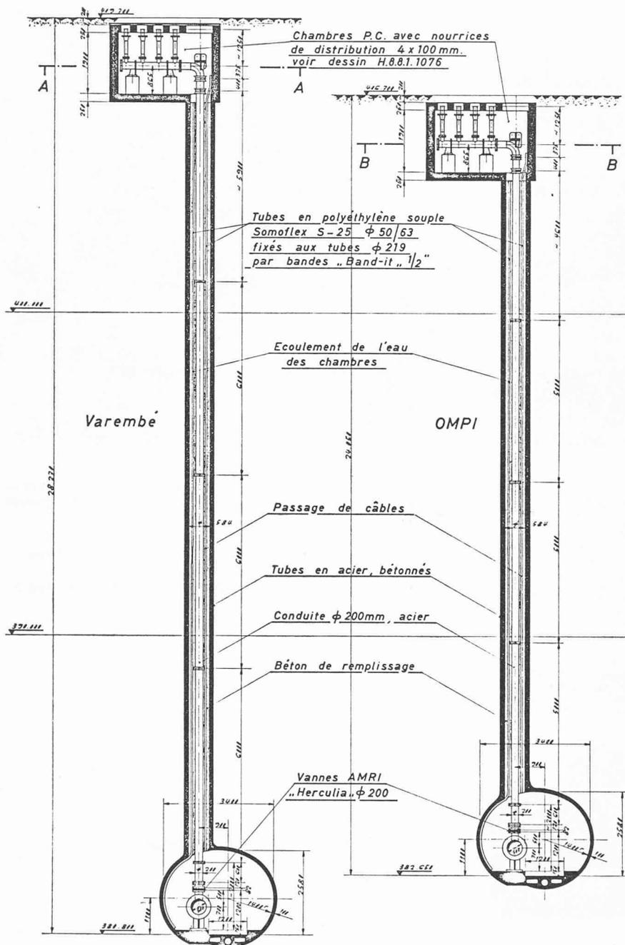
Fig. 28. — Coupe type des forages « Protection civile ».
