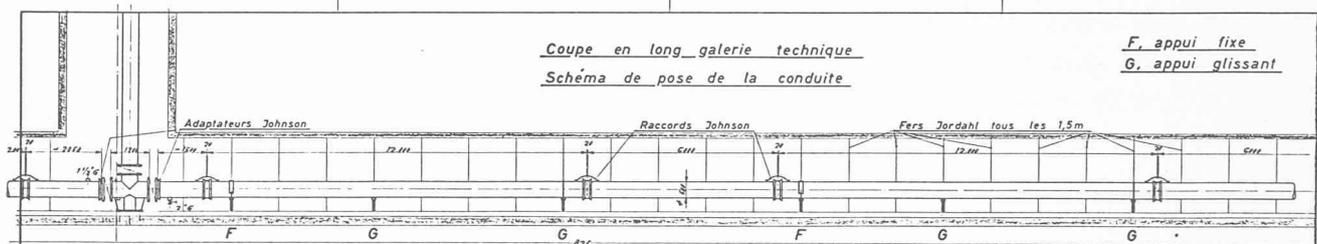
Fig. 24. — Profil en long type de montage de la conduite d'eau, Ø 500 mm.
