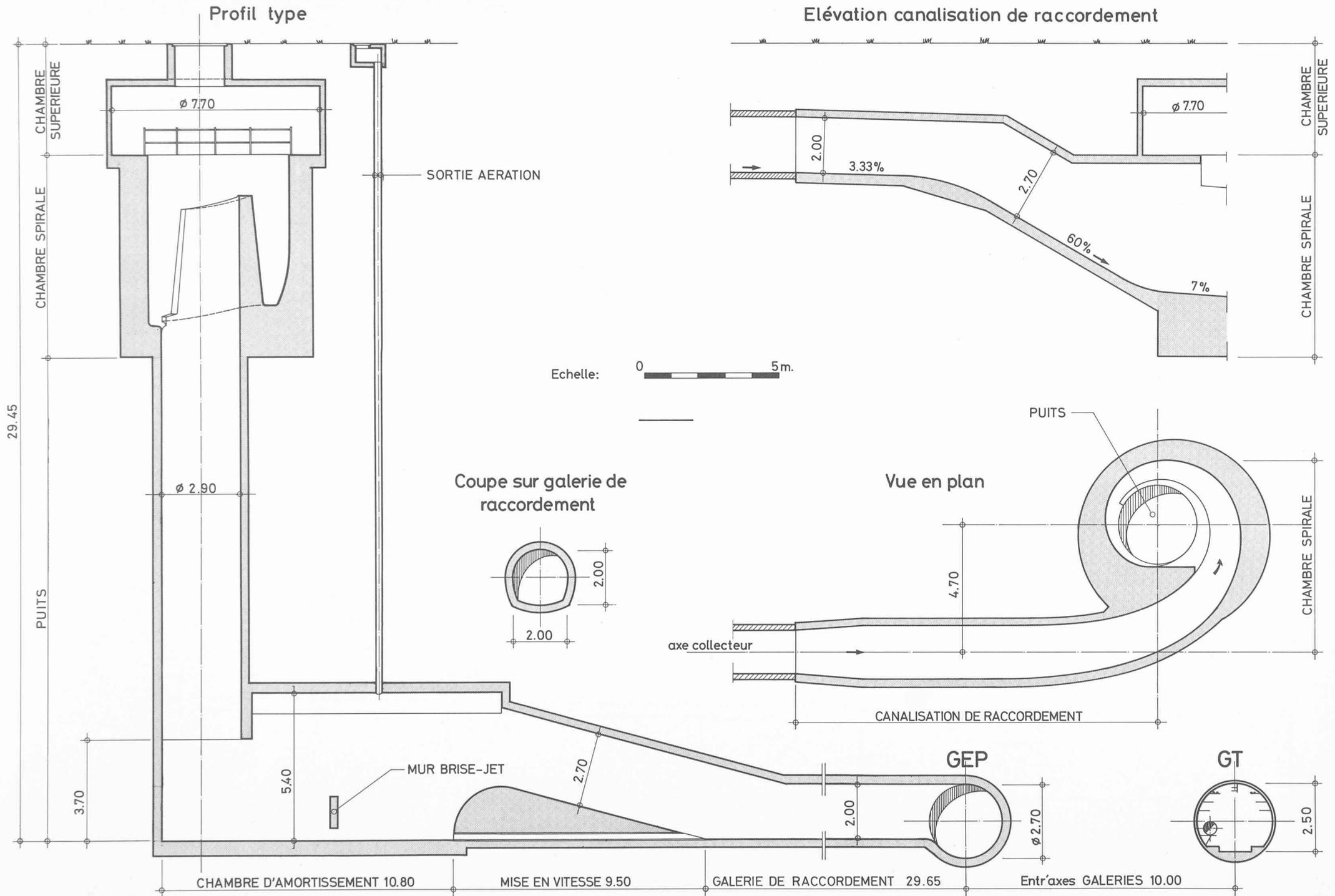
Fig. 14. — Puits de chute Schaub - Trembley - Nations.
