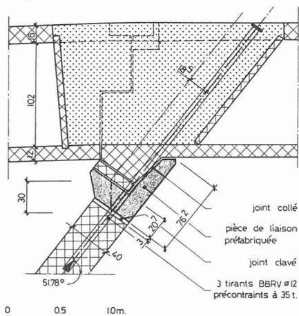
Fig. 3. — Détail de la liaison d'une béquille intérieure.
