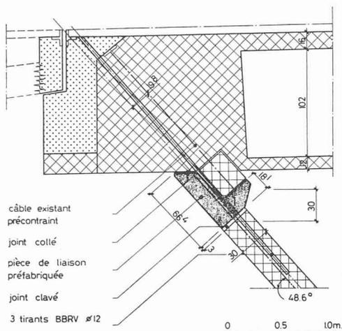
Fig. 2. — Détail de la liaison d'une béquille extérieure.
