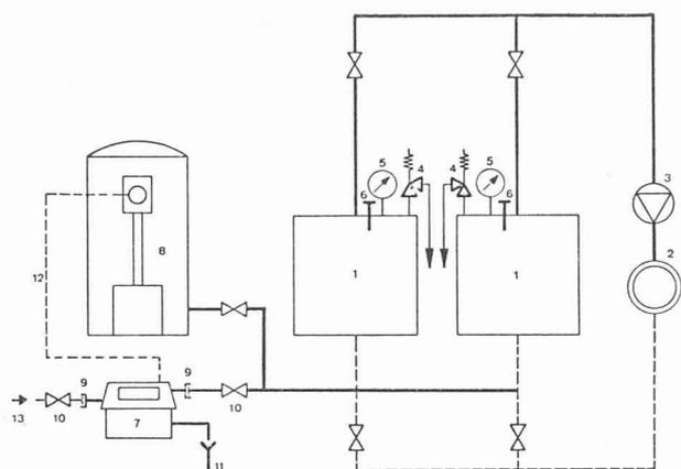
Fig. 4. — Installation avec compensateur à compresseur.
