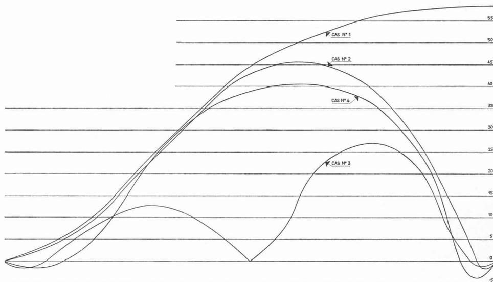
Fig. 14. — Contraintes  $\tau_x$ ; coupe longitudinale C-C.
