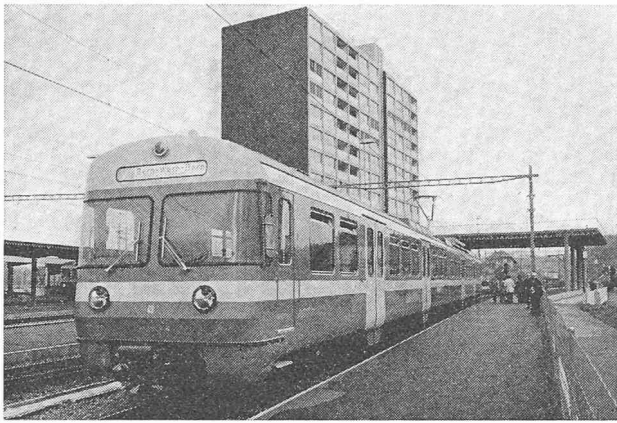
Fig. 2. — Rames de banlieue type SZB/VBW. Longueur totale : 40,0 m, tare : 47,5 t, puissance unihoraire : 440 ch, vitesse maximum : 75 km/h, tension d'alimentation : courant continu 1200 V, 136 places assises. Des rames identiques ont été commandées par les chemins de fer FLP/FART (Tessin).
