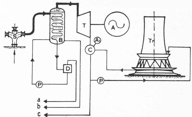
Fig. 8. — Schéma d'installation géothermique à Cycle 2. S = Tête de puits ; B = Echangeur de chaleur ; T = Turbine ; A = Alternateur ; C = Condenseur à mélange ; A<sub>1</sub> = Pompe à vide ; Tr = Tour de refroidissement ; P = Pompe ; D = Dégazeur ; a) = Décharge du gaz ; b) = Décharge des eaux boriquées ; c) = Surplus d'eau. Des eaux boriquées et/ou du gaz peuvent être envoyés aux installations chimiques.
