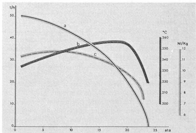
Fig. 6. — Caractéristiques physiques du fluide relevées à la tête du puits. Courbes de débit (a), température (b) et rapport gaz-vapeur (c), en fonction de la pression.
