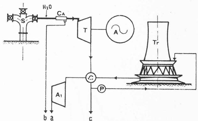
Fig. 9. — Schéma d'installation géothermique à Cycle 3. S = Tête de puits ; H<sub>2</sub>O = Injection d'eau pour le lavage de la vapeur ; C<sub>A</sub> = Cyclone axial ; T = Turbine ; A = Alternateur ; C = Condenseur à mélange ; Tr = Tour de refroidissement ; P = Pompe ; A<sub>1</sub> = Compresseur ; a) = Décharge du gaz ; b) = Décharge des eaux boriquées ; c) = Surplus d'eau.
