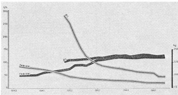
Fig. 3. — Evolution dans le temps du débit et de la température de la vapeur produite de deux puits du champ de Larderello. Les débits sont mesurés à une pression d'environ 4 ata.
