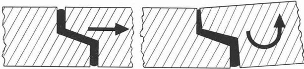
PHASE IV : a) En cas de déboîtement axial partiel, pouvant survenir soit durant la pose, soit en cours d'exploitation, la masse du « BFL-Mastix », grâce à son élasticité, sa plasticité souple ainsi qu'à son pouvoir d'adhésion élevé, est apte à supporter un degré d'étirement important, sans perte d'étanchéité.
