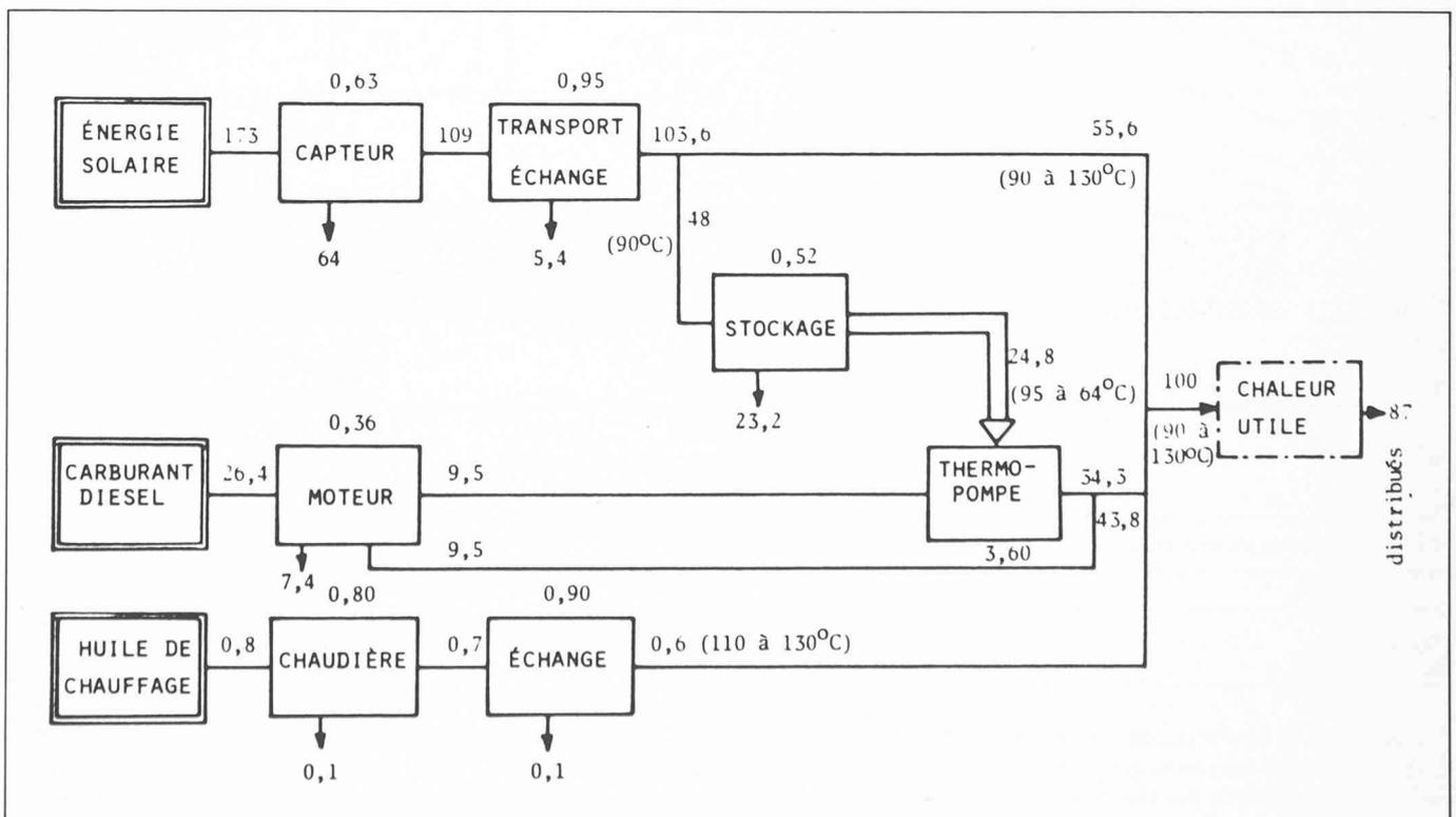
Fig. 8. — Chaîne énergétique du système (moyenne annuelle). 173 = énergie rapportée à 100 produits ; 64 = pertes du constituant ; 0,63 = rendement moyen du constituant ; 3,60 = COP des thermopompes (moyen).
