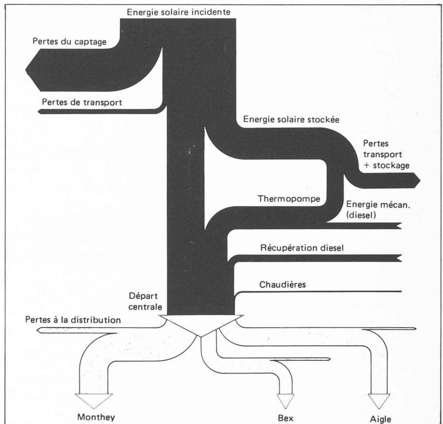
Fig. 7. — Schéma des flux de chaleur.
