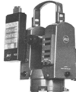
Kern E1. Théodolite électronique avec enregistreur
