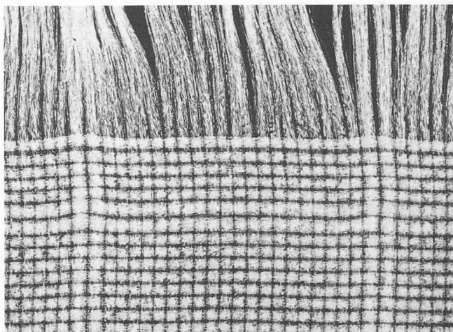
Fig. 5. — Tissé multifilament dans les deux sens.
