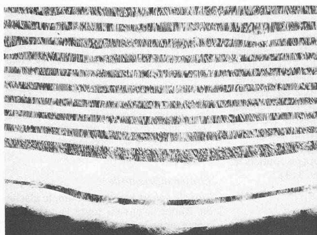
Fig. 6. — Tissé mixte mono-/multifilament.
