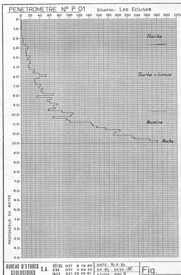
Fig. 8. — Résultats des sondages au pénétromètre.
