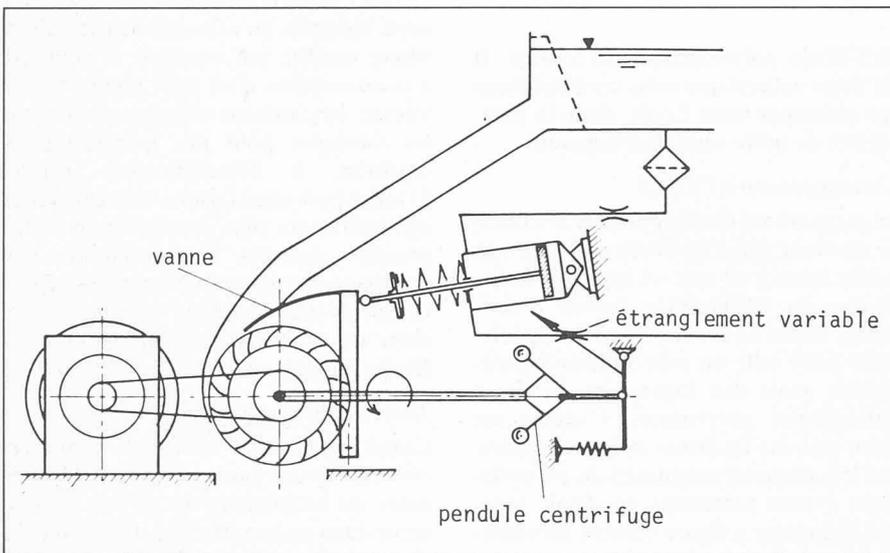
Fig. 3. — Schéma de réglage de la turbine destinée au Népal.
