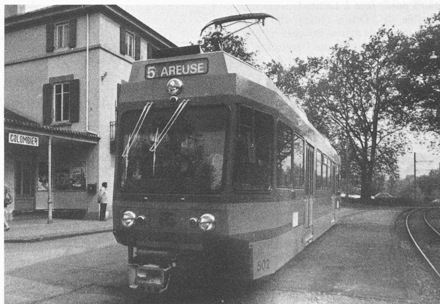
Fig. 25. — Capacité élevée, accélération rapide grâce aux hâcheurs, excellent confort du roulement, faible niveau de bruit: le tram moderne (Be 4/4 des Tramways neuchâtelois; constructeurs: SIG/BBC).
