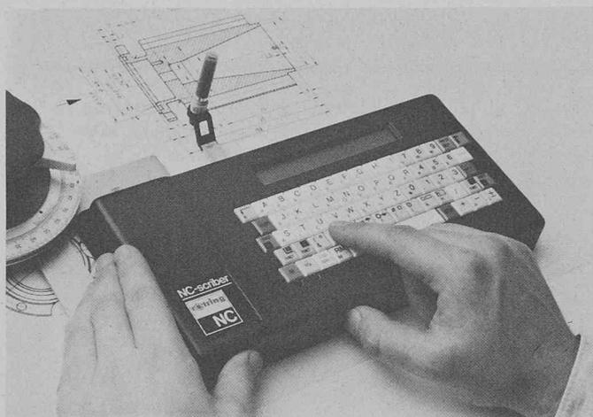
Le rottring NC-scriber est adaptable sur les raccords de règle du bouton de réglage d'une machine à dessiner.
