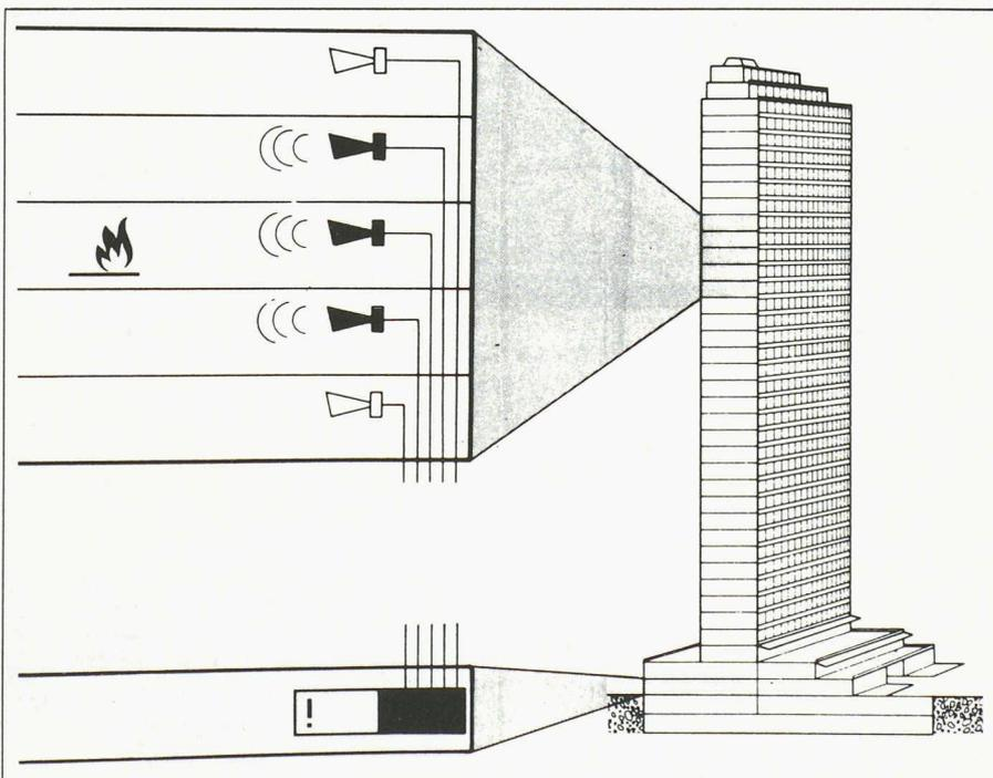
Fig. 6. — Exemple d'une alarme par secteur.
