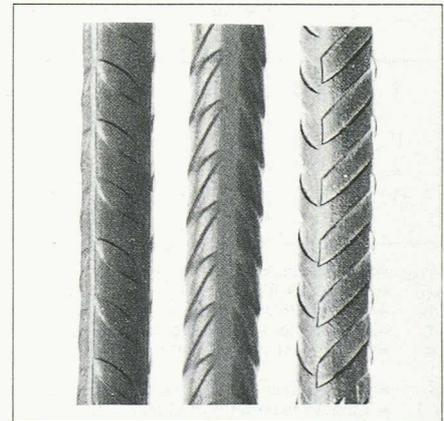
Fig. 4. — Fils d'acier profilés des treillis d'armature suisses.
