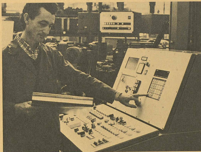
Usinage rationnel en petite série: la famille d'automates programmables Simatic S5.
