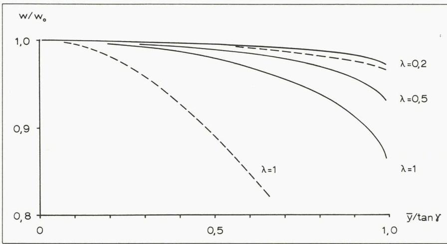
Fig. 5. — Répartition de la vitesse verticale  $w/w_0$  à travers l'aile calculée par  $w(\Delta\bar{\eta}_i) = cte$  (—) et par  $dw(\Delta\bar{\eta}_i)/d\bar{y} = cte$  (- - -) avec variation du paramètre de l'entoilage  $\lambda = q_\infty/F_1$ .
