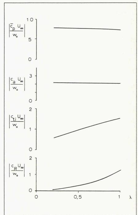
Fig. 7. — Les coefficients de pression ( $\bar{c}_p$ ), de portance ( $c_a$ ), de traînée induite ( $c_{ii}$ ) et du raccourcissement latéral ( $c_R$ ) en fonction du paramètre de l'entoilage  $\lambda = q_\infty/F_1$ .
