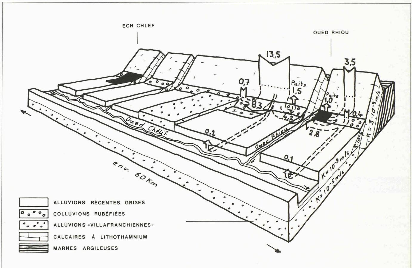
Fig. 3. — Bilan des débits souterrains (en millions de m<sup>3</sup>/an).
