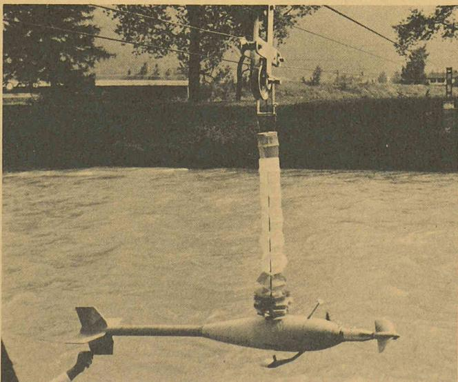
Le moulinet, fixé sur la partie droite du saumon, tourne à une vitesse qui est fonction de la vitesse de l'eau. Le saumon, muni d'ailettes stabilisatrices, permet d'immerger et de stabiliser le moulinet dans le cours d'eau à l'endroit désiré. Les impulsions produites par le moulinet et le détecteur de fond (visible sous le saumon) sont transmises en surface par un câble électrique.
