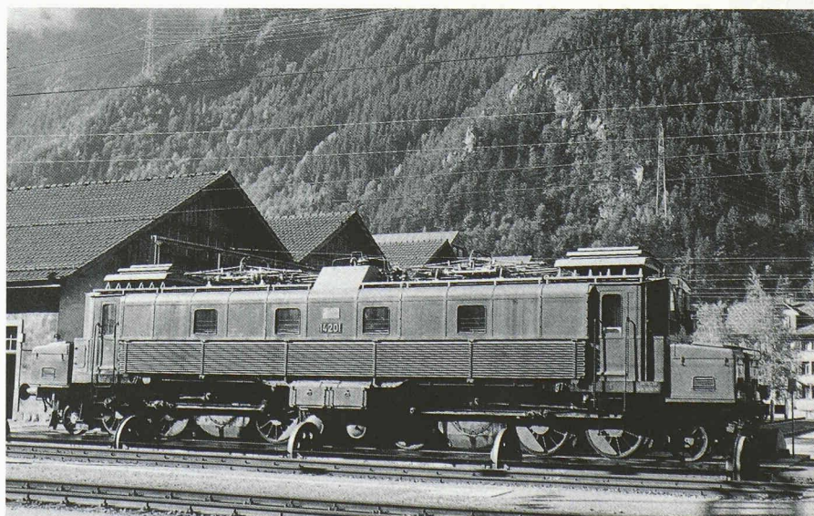
Fig. 5. — Un vétéran au repos devant le dépôt d'Erstfeld en 1981, Ce 6/8 1 14201. Cette locomotive livrée en 1920 est la seule survivante des quatre prototypes livrés en 1919 et 1920 aux CFF. Quelques caractéristiques : masse 99 t, vitesse maximale 65 km/h, puissance unihoraire 1750 kW à 41 km/h. Ce véhicule ne doit sa survie, en 1967 — à une époque où l'on ne s'intéressait pas encore assez à ces témoins pionniers de l'époque de l'électrification —, qu'au fait que la division de la traction et des ateliers avait besoin d'une locomotive pouvant exercer un effort de traction non négligeable pour les trains d'essais des freins. Après avoir circulé en tête de nombreux trains spéciaux quelques années comme locomotive historique habillée en brun, la couleur d'ordonnance des locomotives CFF jusqu'en 1927, la Ce 6/8 1 14201 est entrée en 1982 à la Maison suisse des Transports à Lucerne à l'occasion de l'inauguration de l'agrandissement des halles ferroviaires pour le centenaire de la ligne du Saint-Gothard. (Photo R. Schorno)
