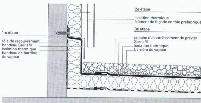
Etanchement en étapes grâce à la soudure thermique.
