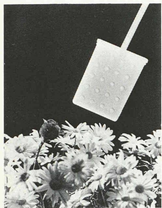
Ce capteur fait partie du nouveau système de détection chimique pour la surveillance de l'air dans les entreprises industrielles, ICAMS testé dans l'usine IBM de San Jose, en Californie. Sa sensibilité est telle qu'il peut être calibré pour déceler le parfum d'une seule rose au milieu d'un parterre de marguerites.
