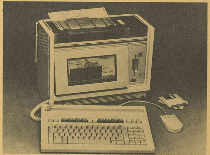
L'Intégral PC constitue un système complet portable, puisqu'une imprimante Thinkjet y est incorporée (la souris est en option).
