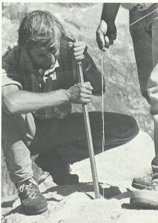
Afin de «radiographier» avec des ondes acoustiques les environs du laboratoire souterrain de la Cédra au Grimsel, on y a fait détoner de faibles charges explosives. Ce même procédé sera également utilisé pour les sondages en vue du stockage final des déchets de faible et moyenne radioactivité.
