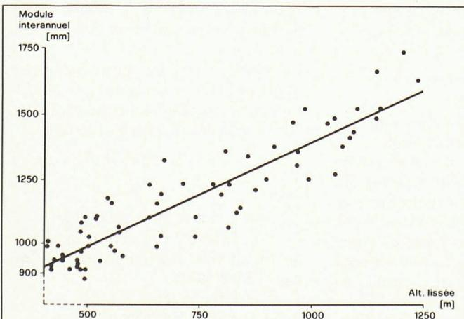
Fig. 4. — Régression altitude lissée (fenêtre 6 × 6 km) — module interannuel.
