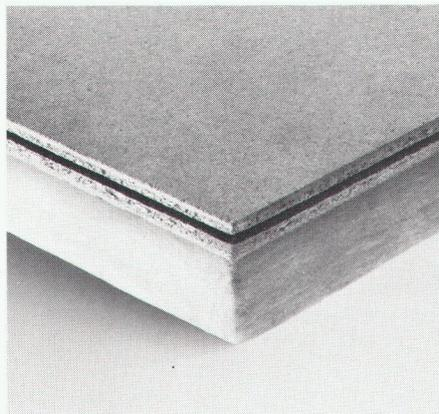
Les éléments isolants HOMISOL sont constitués d'un panneau de particules-support et d'une couche isolante en mousse de polyuréthane ou en laine de verre. Les panneaux HOMOGEN peuvent être obtenus dans les qualités Standard, hydrofuge ISO V100, ou ignifuge IG V100. La liaison rainure et languette garantit des surfaces planes continues.
